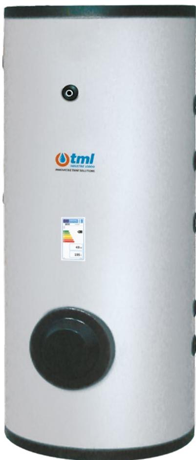
Δοχείο αποθήκευσης για ζεστό νερό χρήσης (ZNX) που παράγεται από εξωτερικές πηγές (λέβητες, πλακοειδείς εναλλάκτες). Το δοχείο είναι κατασκευασμένο από ανθρακούχο χάλυβα και προστατεύεται εσωτερικά με γυάλινη επίστρωση (για χωρητικότητες έως 2.000 λίτρα) ή με κεραμική επίστρωση Keramtech (για χωρητικότητες από 2.000 έως 5.000 λίτρα). Η θυρίδα επιθεώρησης μπορεί επίσης να χρησιμοποιηθεί για τον εξοπλισμό του δοχείου.
