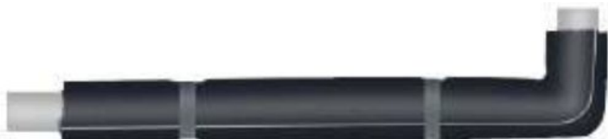
Μόνωση των σωληνώσεων. Τα χειριστήρια των βανών παραμένουν εκτός μόνωσης.
